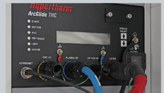
弧压式自动调高装置 Arc automatic height controller
